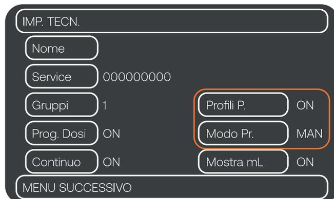
Una volta impostato su Automatico o Manuale, sulla schermata principale apparirà un menù per la gestione dei Profili, nel caso in cui sia impostata in manuale la regolazione della pressione (0,5...12 bar) avverrà analogicamente andando ad agire su una ghiera intorno alla tastiera, presente se la macchina è dotata del Kit Profilo di Pressione, (vedi Manuale d'Uso per funzionamento ghiera).
