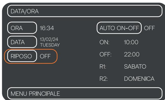
In modalità stand-by (nessun allarme e nessuna erogazione in corso), dalla schermata principale sarà possibile entrare in modalità ECO od OFF (in base a quanto selezionato sotto la voce Riposo all'interno del menu Regolazione orologio).
