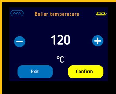
На этой странице Вы можете установить температуру в бойлере (горячей воды и пара) с помощью клавиш «+» и «-». Чтобы сохранить настроенные значения, нажмите кнопку «Подтвердить».
