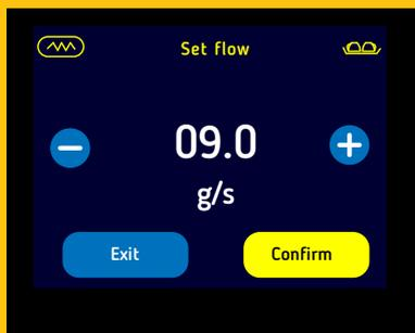
Используя клавиши «+» и «-», установите параметры потока. Сохраните установленные настройки, нажав на значок «ПОДТВЕРДИТЬ».
