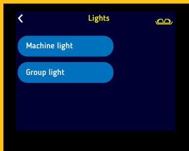
При нажатии кнопки «Световые индикаторы» отобразится страница, позволяющая включать/выключать световые индикаторы кофемашины.
