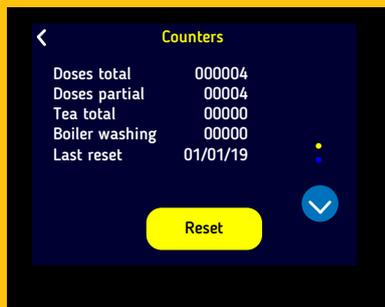
При нажатии кнопки «Счетчики» откроется страница, отображающая данные общего счетчика и счетчиков отдельных параметров, установленных в кофемашине.
