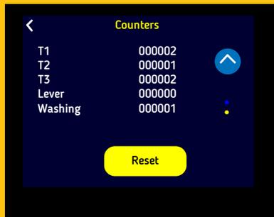
На второй странице меню «Счетчики» отображаются данные счетчиков порций каждой заварочной группы, а также количество операций с рычагом и количество выполненных циклов очистки.
