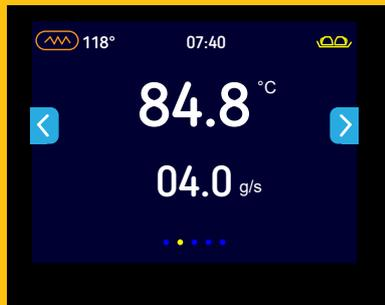
На второй странице главного меню отображается заданная температура (в °C) и расход кофе (в г/с), установленные при настройке при помощи ключа.
