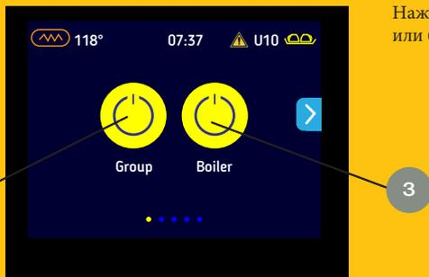
Нажмите на значки [2] или [3], чтобы включить/выключить соответствующую заварочную группу или бойлер (значок станет желтым).
